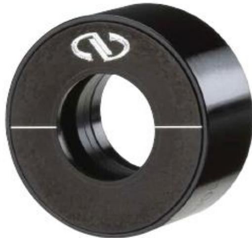
これらのアクロマティック0次波長板は、水晶とフッ化マグネシウムという異なる2つの複屈折結晶からなり、エアスペース構造を採用しています。アクロマティック水晶-MgF<sub>2</sub>波長板では、広い波長範囲で0次水晶波長板よりも優れた位相遅れ精度が得られます。アクロマティック水晶-MgF<sub>2</sub>波長板は、アクロマティックポリマー薄膜波長板よりも低価格で、損傷しきい値も高くなっています。25.4 mmのハウジングにマウントされ、可視領域から近赤外領域までの3つの波長で $\lambda/4$ または $\lambda/2$ の位相遅れを選択できます。
